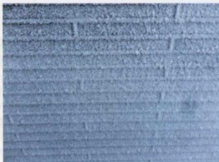
Figure 25 - Givrage d'un capteur
